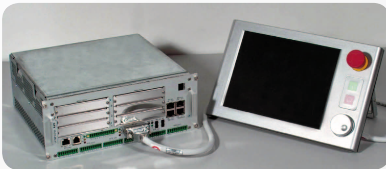
Abb 2: Die Lasersteuerung von TRUMPF im einbaufertigen Semi-Custom-Design von Kontron.
