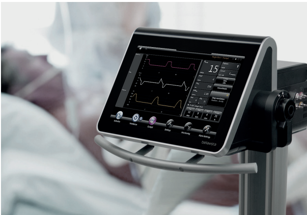
// GRAFIK: DAS INTEGRIERTE KONTRON-MODUL ÜBERNIMMT DIE ANZEIGE UND VISUALISIERUNG DER AKTUELLEN BEATMUNGSPARAMETER
